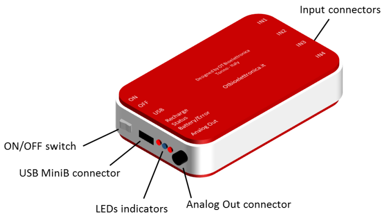
FIG. 7.1: Controlli, indicatori e connettori del Quattro
