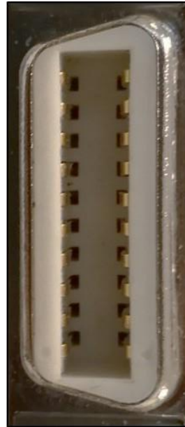
FIG. 8.9: Connettore C1, uscita analogica e ingress Trigger (micro D Sub 20 poli – N. 3M-10220-6212PL).
